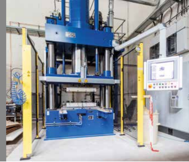
Bild Heißpresse für 2D- und 3D-Formpressteile im WKI-Technikum.
