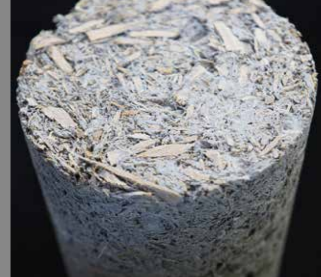
Bild Testkörper aus einem Holz-Beton-Hybridwerkstoff.
