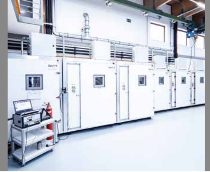
Bild Prüfkammern mit sechs Kubikmetern Volumen.
