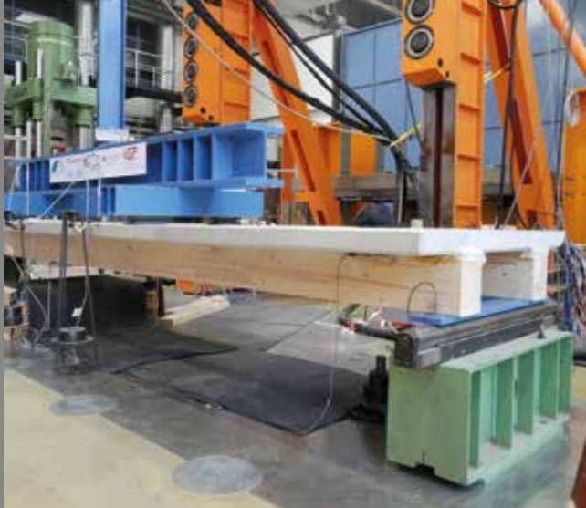
Bild Tragfähige Holz-Beton-Verbundelemente durch Schnellklebtechnik mit langen Spannweiten (> 6 m).
