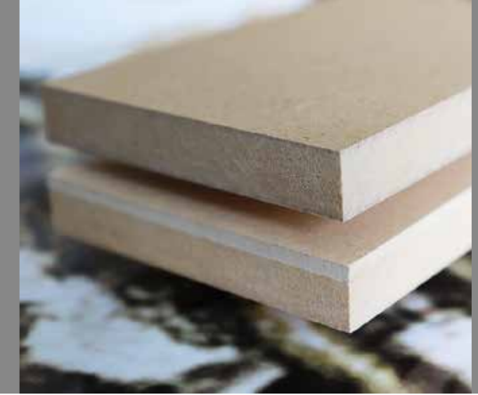
Bild Mitteldichte Holzfaserplatten (MDF) mit einem Anteil Rübenpellets.
